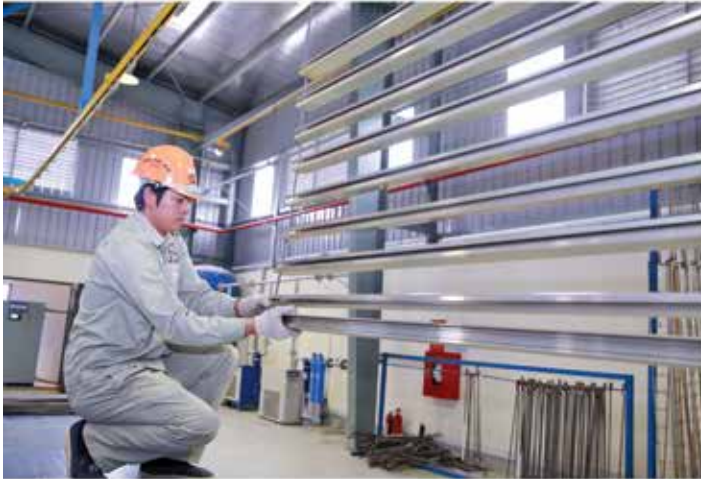
Thanh nhôm sau hoá già đạt tiêu chuẩn chất lượng kiểm tra được chuyển sang phân xưởng xử lý bề mặt
