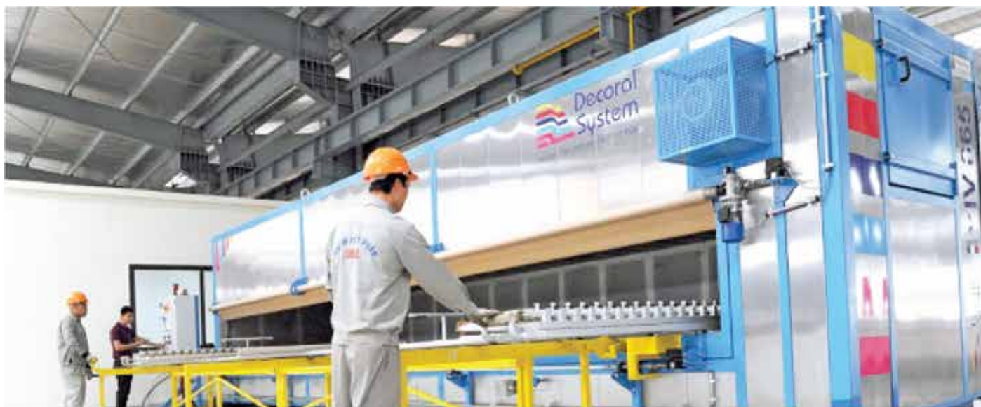
Hệ thống sấy và hút chân không tự động DECORAL SYSTEM
